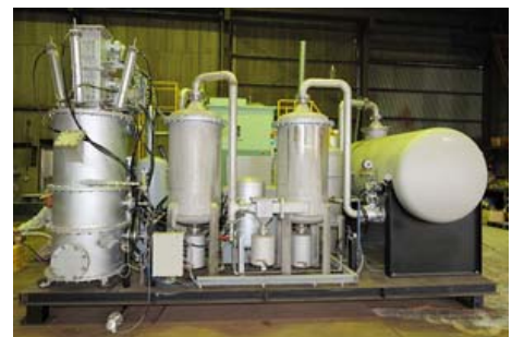
図6. ガス生成装置
